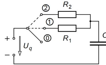
Zur Zeit  $t_0 = 0\ \text{s}$  wird der Schalter in die Position 1 gedreht.
